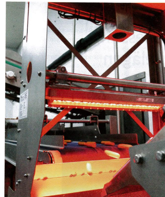
Bild 2. Mit 2 m/s fliegen die Würstchen zwischen zwei Zeilenkameras vorbei, die so positioniert sind, dass sowohl Ober- als auch Unterseite der Würstchen inspiziert werden kann. (© Stemmer Imaging)
